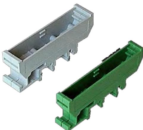
Vaschetta interfaccia bipasso brevettata per singoli relè e fotoaccoppiatori, disponibile in lunghezza 11.5 mm (RS2) e 16.5 mm (RS3), con lo stesso laterale sinistro e con laterale destro di due diverse profondità. Larghezze compatibili con la serie Mini, ma con aggancio integrato nel laterale sinistro.
